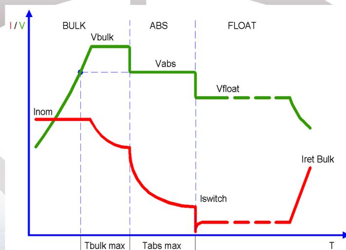
\*Ciclo personalizzato è programmabile solo dal service. / Customized cycle can only be programmed by service. Questo ciclo consente di caricare ogni tipo di batteria / This cycle allows the recharging of any battery type.
